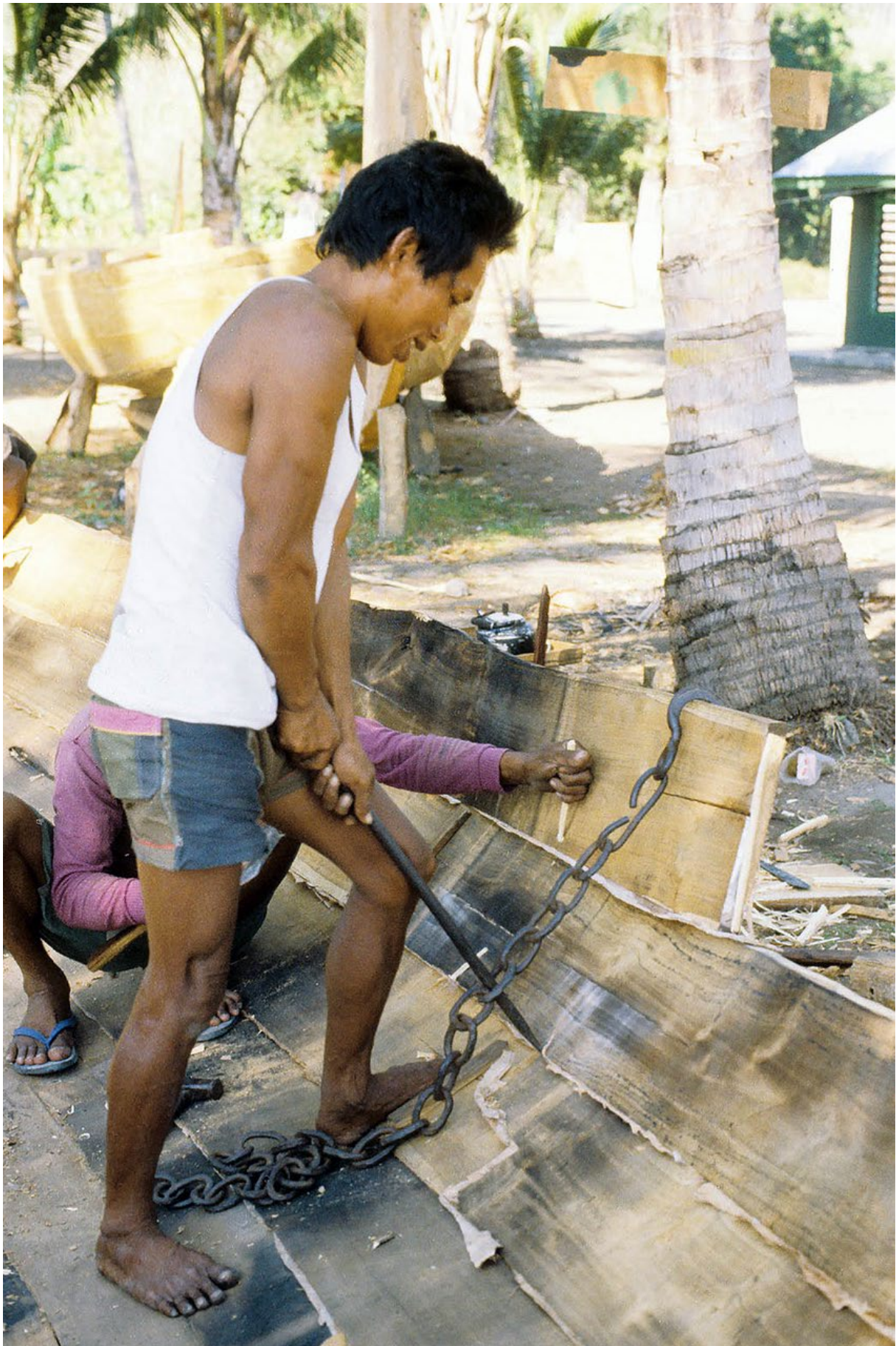
Bordés en cours d'assemblage avec contre-chevillage, Pantai Pecaron, Java Centre, 1981.
