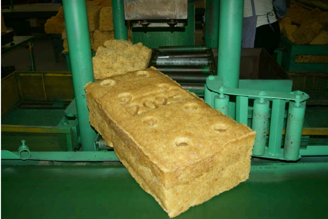
Figure 8 : Dans l'usine, les blocs de caoutchouc passent par différentes étapes de traitement : tri, élimination des impuretés, séchage, pesée et découpe. Ils deviennent alors des semi-produits de couleur brun jaunâtre, avant d'être envoyés vers des usines plus éloignées pour une seconde transformation, plus fine et plus spécialisée.
