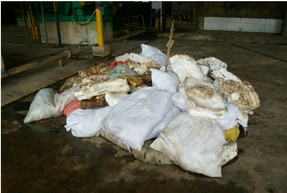
Figure 6 et 7 : Une fois récolté, le latex est mélangé à de l'acide formique, ce qui le fait coaguler en blocs. Dans les abris de montagne, ces blocs sont grossièrement préparés puis, après en avoir accumulé une certaine quantité, les villageois les transportent vers l'usine de transformation la plus proche. La figure 7 montre des blocs de caoutchouc, issus de différents foyers, empilés les uns sur les autres.
