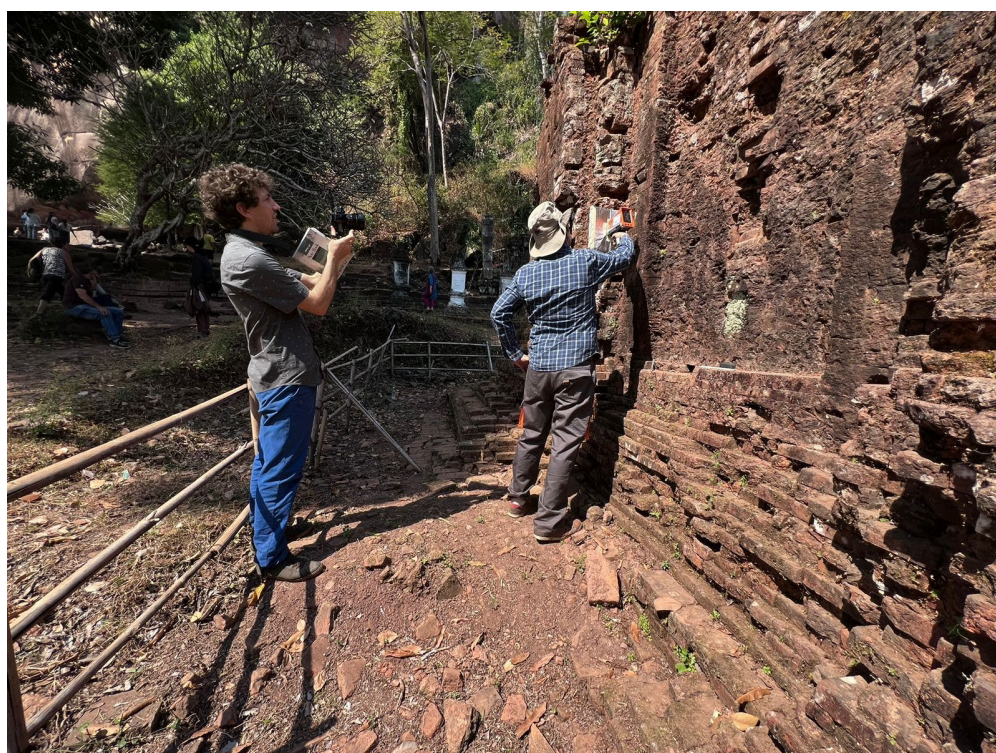
Figure 15 : Utilisation du spectromètre XRF par David Bourgarit et Brice Vincent sur le sanctuaire principal de Vat Phou
